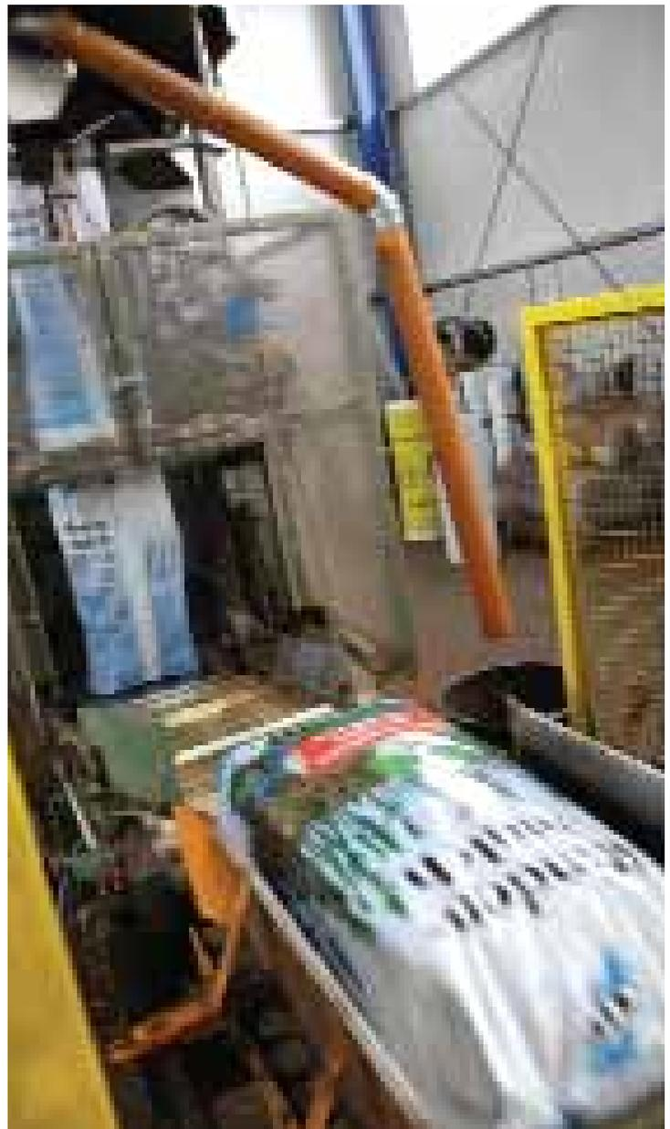
**CLOCKWISE FROM LEFT: LOGS ARE BROUGHT TO THE SITE FROM THE SURROUNDING FOREST AND PROCESSED INTO MULCH. THE SCREENED MULCH IS TAKEN TO THE ON-SITE FACILITY WHERE IT IS PUT INTO 50 OR 60-LITRE BAGS. ZOLLIKOFER HOLZ BAGS 300 PALLET-LOADS OF MULCH PER DAY.**
