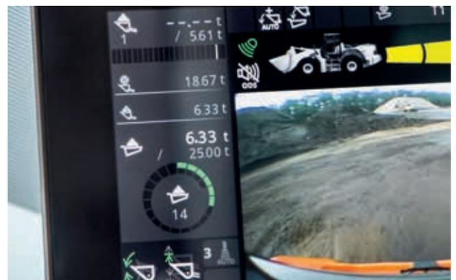
Dank des Payload Checkers können Sie produktiver und genauer beladen.
