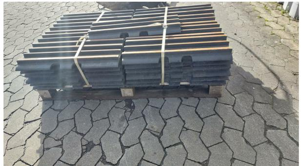
**Hitachi, Bodenplatten 650mm Zweisteg,
