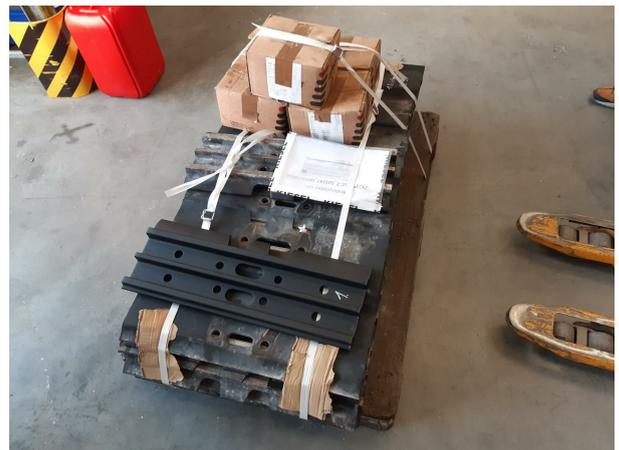
**Hitachi, Dreisteg Bodenplatten 600mm,
