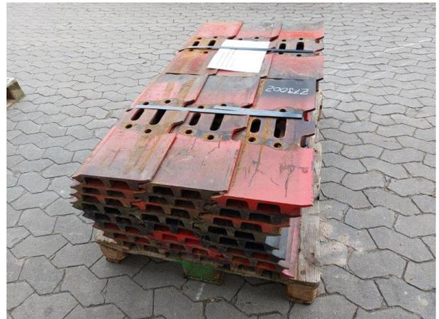
**Hitachi, Bodenplatten 600mm Dreisteg,
