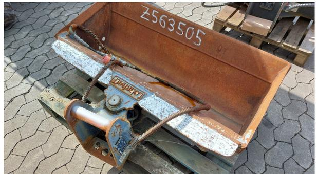
**Lehnhoff, Grabenräumlöffel schwenkbar
