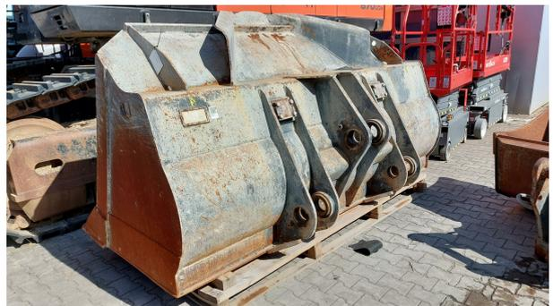
**LRT, Erdbauschaufel 2980 mm, Hitachi ZW250**
