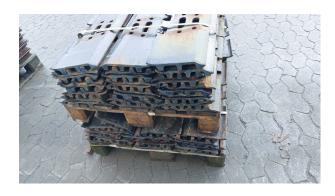
Hitachi, Bodenplatten 600mm Dreisteg, ZX210LC - 3
