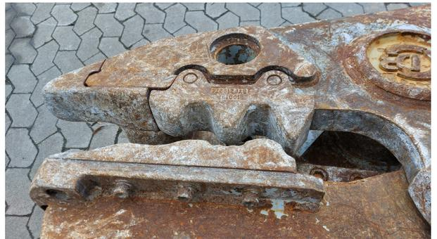
**Demarec, Betonpulverisierer DLP16,
