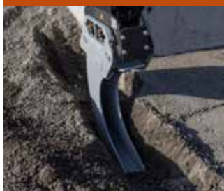
Zagęszczanie: Zagęszczarka do kabli
