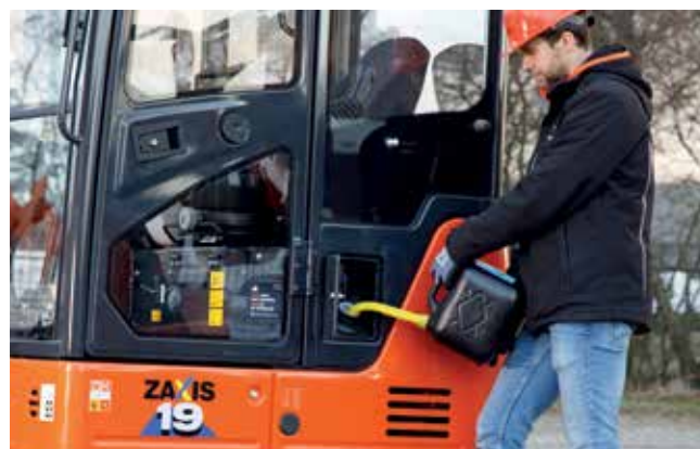
Przeniesiony w inne miejsce otwór zbiornika paliwa ułatwia tankowanie
