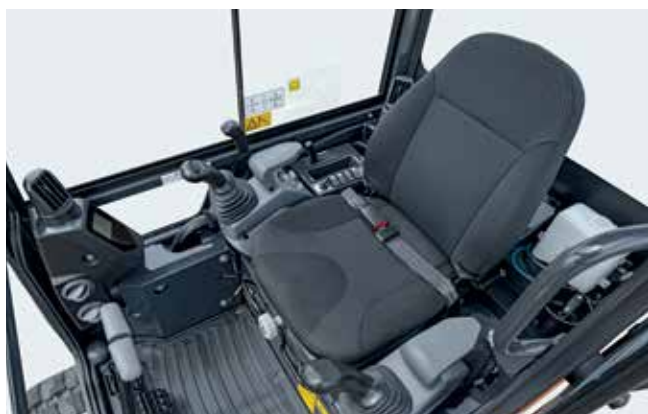
Duże okno po prawej stronie przesuwa się do tyłu w celu zapewnienia doskonałej widoczności.
