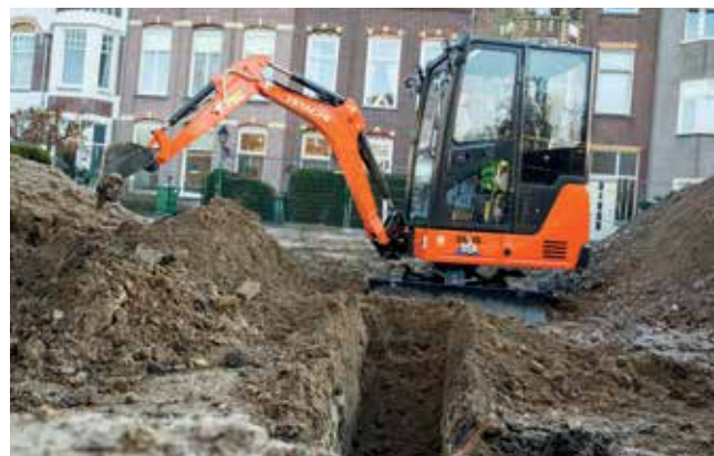
Cylinder wysięgnika umieszczony na górze wysięgnika minimalizuje czas przestoju dzięki redukcji kontaktu z cylindrem.
